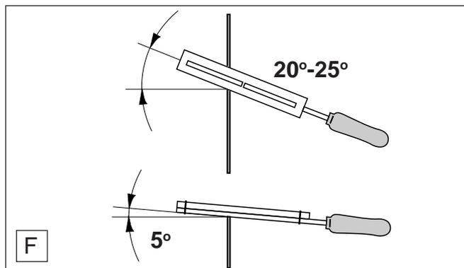
Следует обязательно выдерживать угол заточки в  $20-25^\circ$  (F). Для этого надо вести держатель напильника так, чтобы его маркировка была параллельна режущему полотну.
