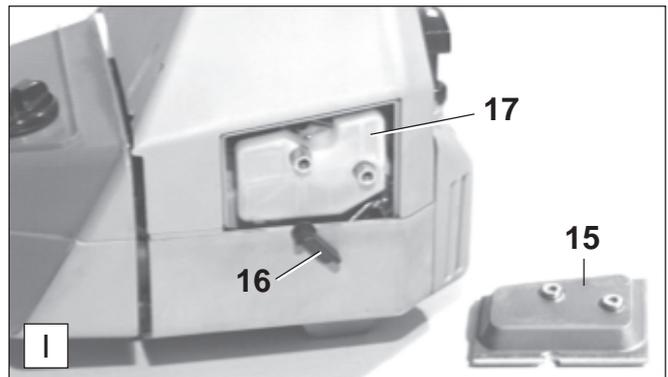
**Внимание: Повреждённый воздушный фильтр следует сразу-же заменить новым! Оборванные куски ткани и крупные частицы грязи могут повредить двигатель.**
