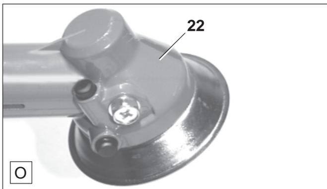
Угловой редуктор (O/22) наполнен смазкой длительного действия и поэтому не требует технического обслуживания.
