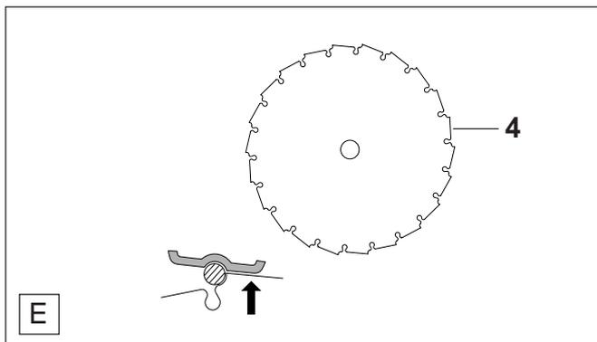
Затачивать следует только переднюю грань зуба. Держатель напильника при этом должен прилегать и опираться на спинку зуба (стрелка).
