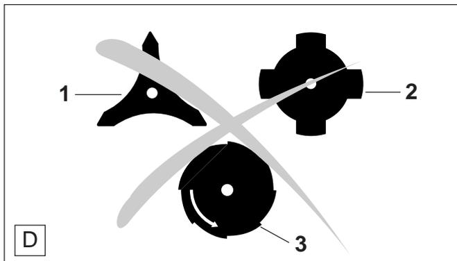
**Внимание:** Ниже перечисленный режущий инструмент может затачиваться только в специализированной мастерской, т.к. заточка от руки приводит к появлению небаланса режущего инструмента во время работы, ведущего в свою очередь к повышению уровня вибраций и повреждением машинки.
